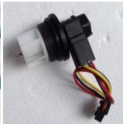
Когда кран открыт, при вращении крыльчатки в схеме создаётся магнитное поле, передаваемое на вторичный преобразователь, после чего на считывающее устройство выдаётся импульс – сигнал определённой частоты.
